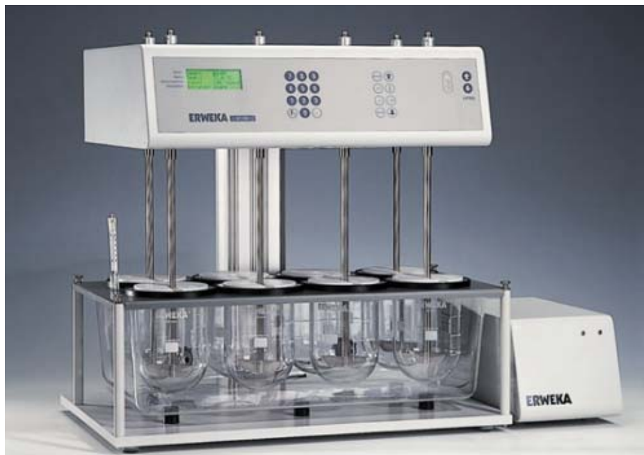
Εικ. 3.18 Συσκευή ελέγχου του ρυθμού διάλυσης των δισκίων (μέθοδος περυγίου).
