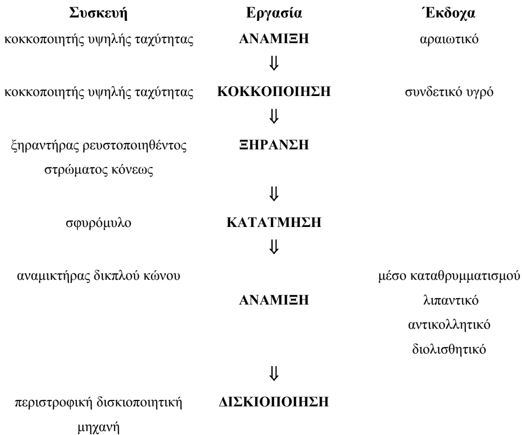
Εικ. 3.11 Διάγραμμα ροής εργασιών κατά την παραγωγή δισκίων με υγρή κοκκοποίηση.
