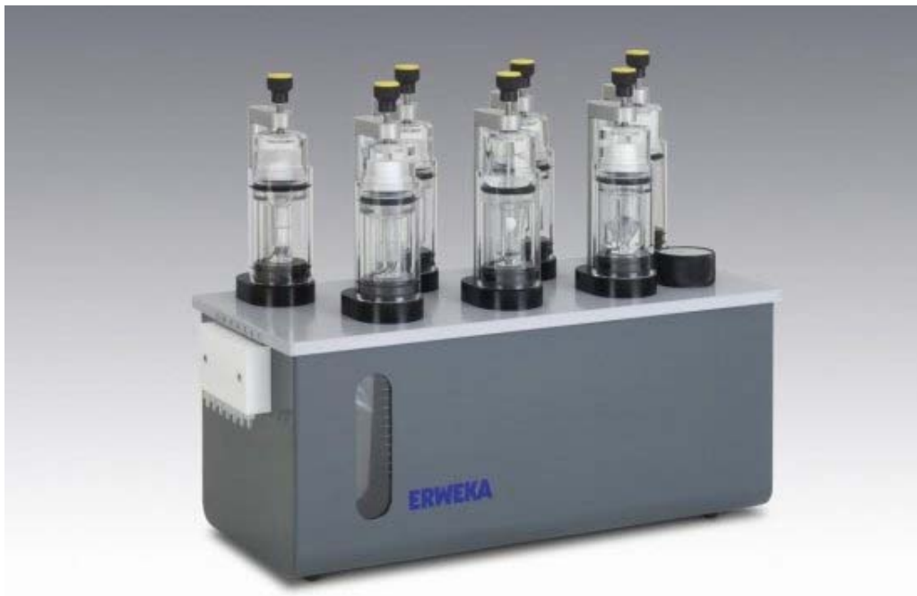
Εικ. 3.19 Συσκευή συνεχούς ροής για τον έλεγχο του ρυθμού διάλυσης των δισκίων.
