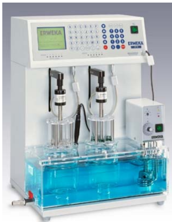
Εικ. 3.17 Συσκευή ελέγχου του χρόνου καταθρυμματισμού των δισκίων.
