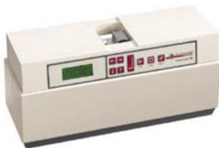
Εικ. 3.15 Συσκευή ελέγχου της μηχανικής αντοχής των δισκίων τύπου Schleuniger.
